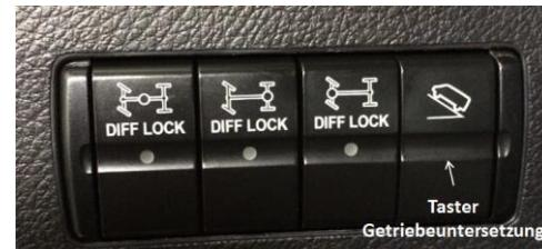
Die Getriebeunterstützung unterstützt bei Fahren auf schwierigem Untergrund. Es gibt 2 Schaltbereiche. Straßenfahrstellung für alle normalen Fahrstellungen und Unterstützung für Fahrten auf schwierigem Untergrund.
