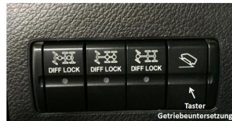
Die Getriebeuntersetzung unterstützt bei Fahrten auf schwierigem Untergrund. Es gibt 2 Schaltbereiche, Straßenfahrstellung für alle normalen Fahrstellungen und Untersetzung für Fahrten auf schwierigem Untergrund.
